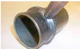
**步骤4**—移去尼龙卡，继续在管道末端一侧完成焊接。焊接无须在气密条件下进行。
