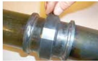
**步骤7**—将两个管道末端平接，胶垫居于中缝处。
