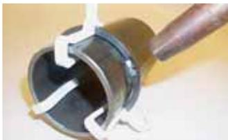
**步骤3**—在尼龙卡间隙位置将连接卡环定位。
