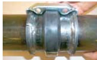
**步骤8**—将TUF-LOK盖罩靠在连接卡环上，紧贴胶垫。
